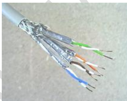
Фиг.2.9 STP кабел
